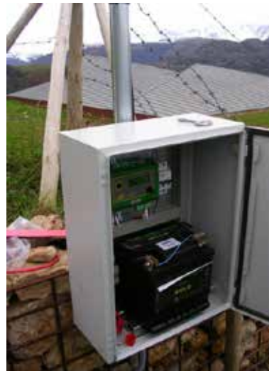
Foto 10.- Estación termopluviométrica instalada en la azotea del edificio de la Cueva de El Soplao
