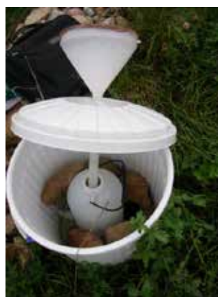
Foto 8.- Pluviocaptor ubicado en la azotea de las instalaciones de la Cueva de El Soplao
