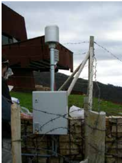
Foto 10.- Estación termopluviométrica instalada en la azotea del edificio de la Cueva de El Soplao
