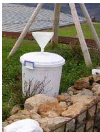
Foto 8.- Pluviocaptor ubicado en la azotea de las instalaciones de la Cueva de El Soplao
