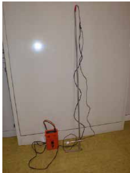
Foto 2.- Equipo de aforo mediante micromolinete
